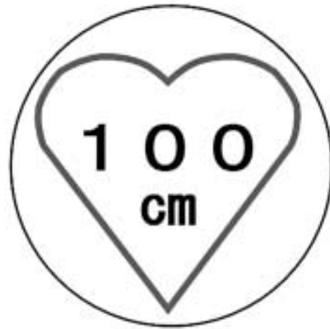
図2 据置きタイプRFID機器用ステッカ (高出力型950MHz帯パッシブタグシステム)
