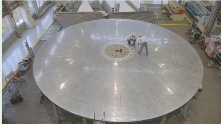
回転式自動製麹培養装置を製作する様子
