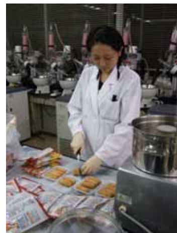
加工食品の残留農薬検査( 粉碎 )
