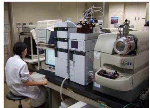
高速液体クロマトグラフ質量分析計による分析
