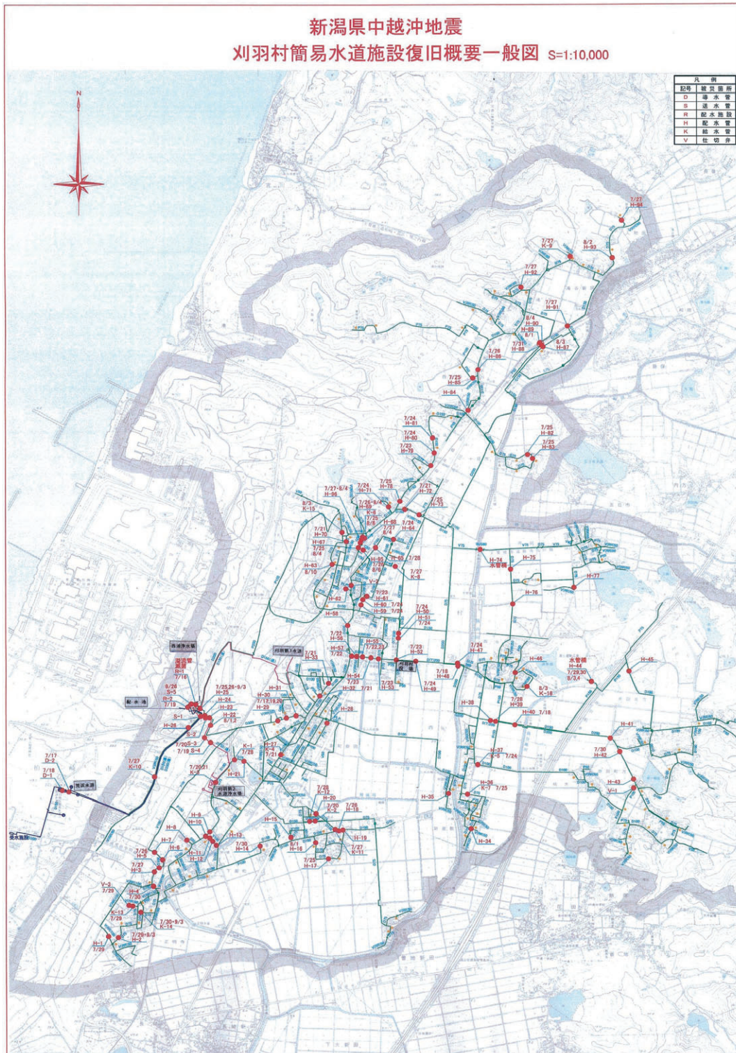
図 4.9 導・送・配水管の被害地点プロット図（刈羽村）
