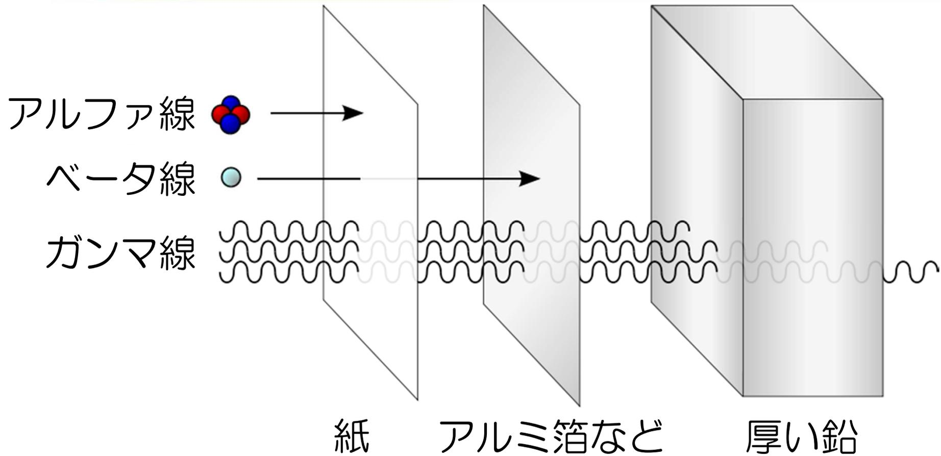
放射線は空気中では遠くには届きにくい。ガンマ線の場合、発生源からの距離が2倍になると、放射線の強さは1/4に減る。アルファ線、ベータ線はガンマ線より届きにくい。
