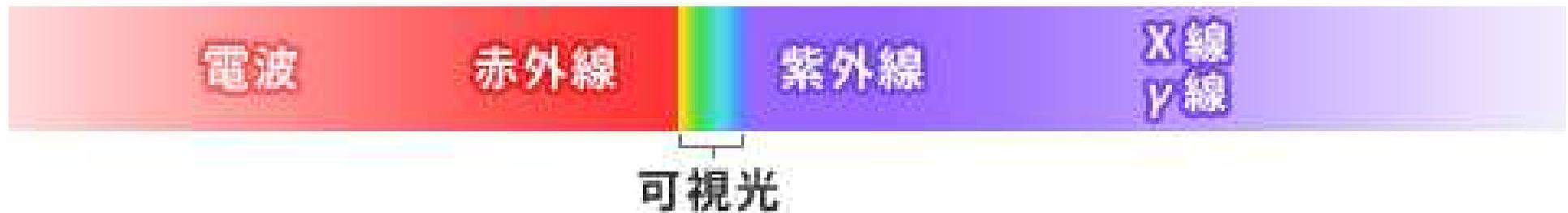
$\gamma$ (ガンマ)線とX線とは発生方法の違いで定義される。そのため、波長で $\gamma$ 線とX線を区別することはできない。
