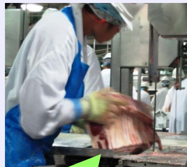
せき柱の除去
