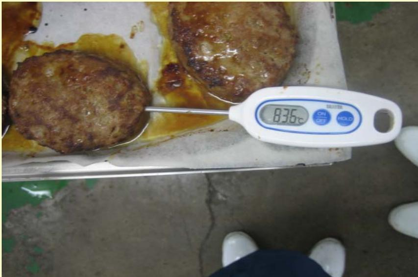
●加熱が済んだ食品について、中心温度計を食材の側面部から中央部に差込み、中心温度を測定する。
