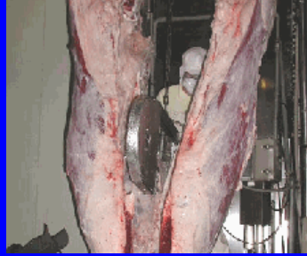
洗浄水をかけながら背割り （鋸屑飛散の防止）
