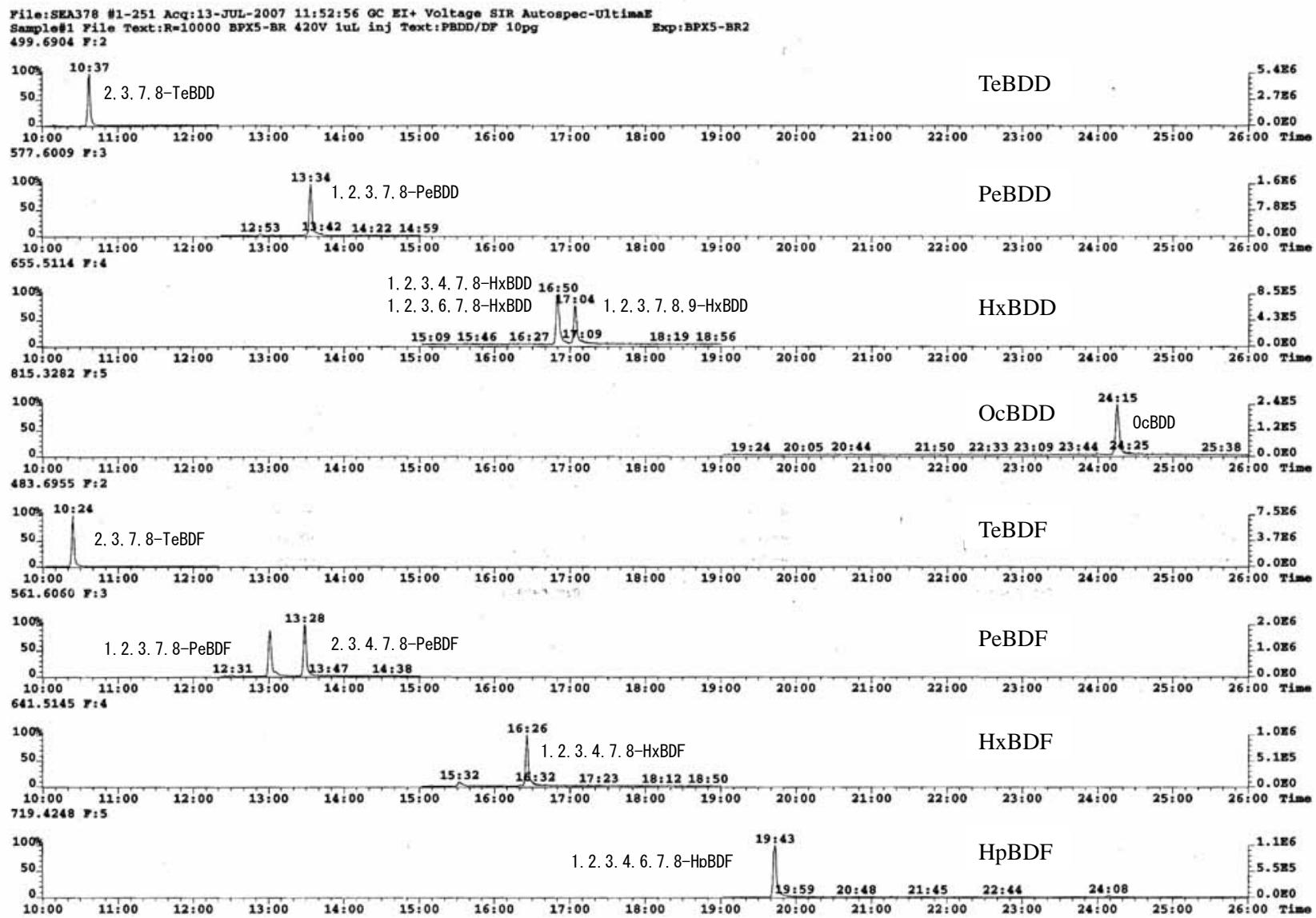
図 8 PBDD/DFs のクロマトグラム (GC カラム : SLB-5MS, 30 m×0.25 mm, 0.1  $\mu$ m)
