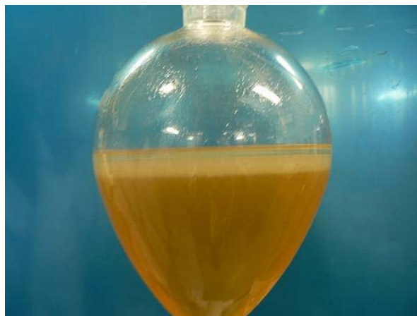
写真 1 A 法でのヘキサン抽出時のエマルジョン生成
