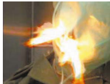
酸素がタバコの燃焼を助けて一気に炎が拡大します。
