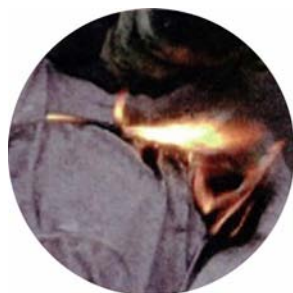
溶けた部分から炎を噴出し、導火線のように着衣に燃え移っていきます。
