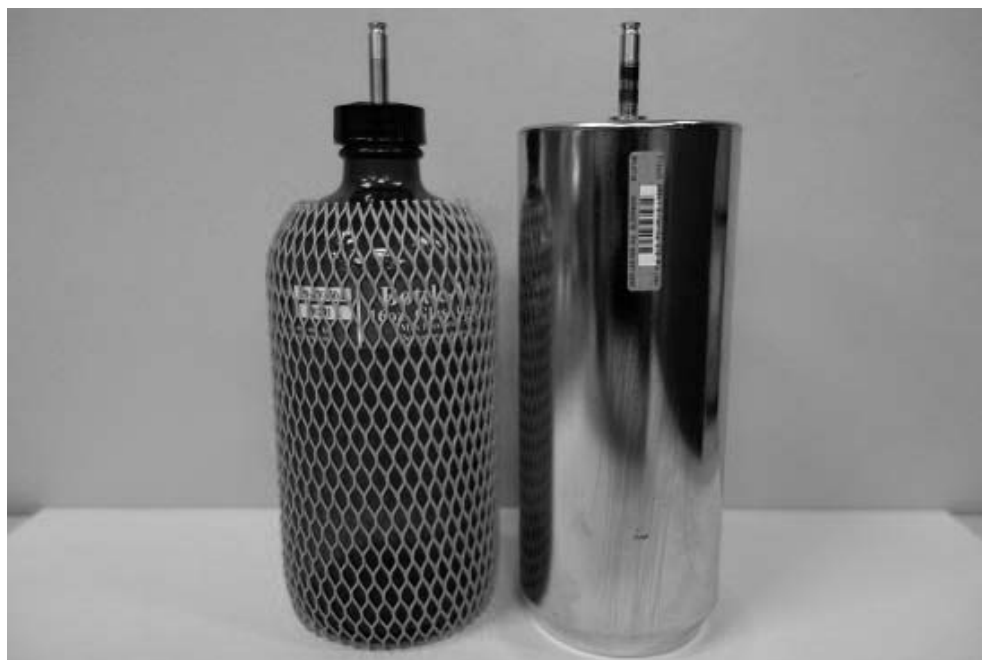
500mL ガラス製キャニスター(左) と 0.6L ステンレス製キャニスター(右)
