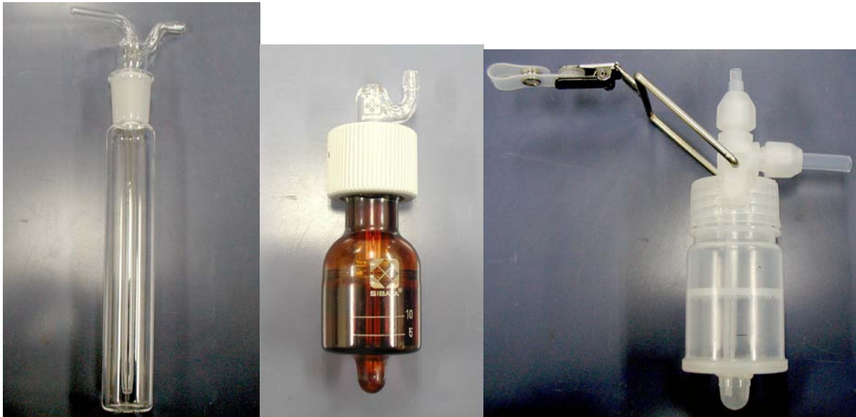
a) 石英製ミクロインピンジャー b) ガラス製マイクロインピンジャー c) ポリプロピレン製マイクロインピンジャー 写真1 インピンジャー
