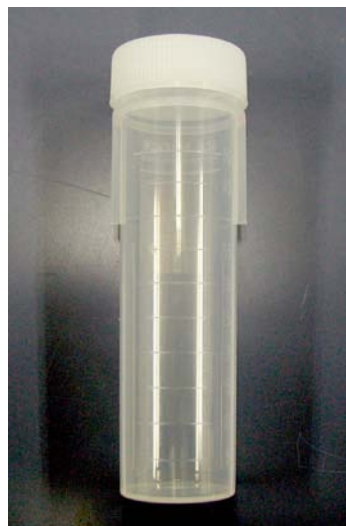
写真2 計量目盛付きのポリプロピレン製保存容器 (GLサイエンス製 DigiTUBEs 65mL)
