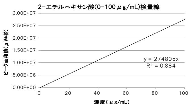
図 4-1 検量線 (0~100  $\mu\text{g/mL}$ )
