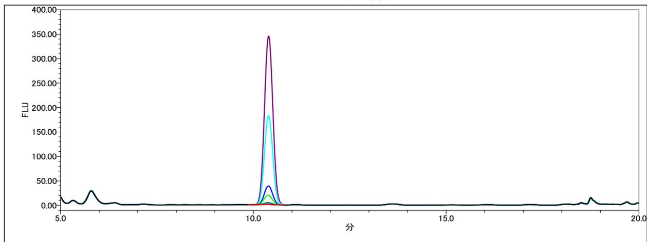
図 5-2 2-エチルヘキサン酸 ADAM 誘導体標準溶液 (0、0.05、0.1、0.5、1、5、10  $\mu\text{g/mL}$ ) の
