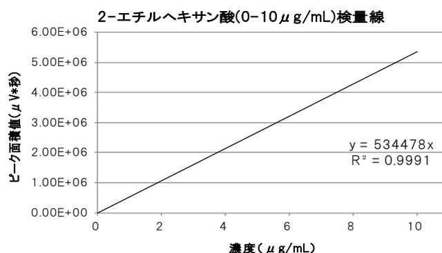
図 4-2 検量線 (0~10  $\mu\text{g/mL}$ )
