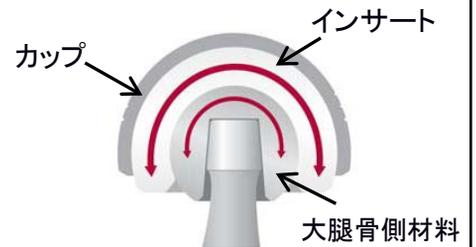
カップとインサートを組み合わせた図(2つの赤矢印が二重摺動面)
