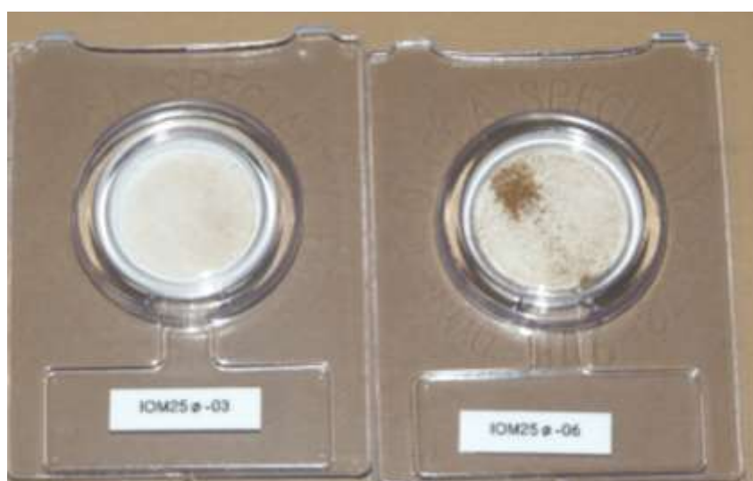
図 2 粉じん濃度 14.4mg/m 3 のフィルター (左) 148.16mg/m 3 のフィルター(右)
