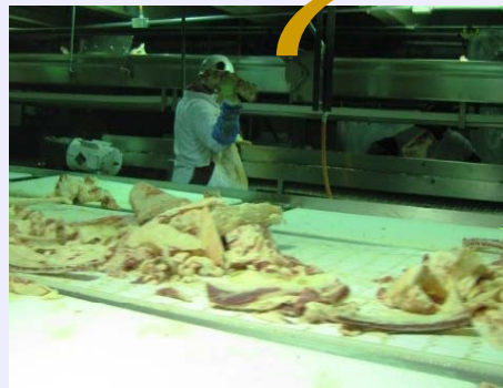
せき柱とそれ以外を仕分け →ベルトコンベアーで搬出
