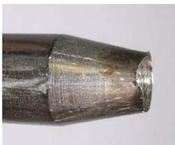
バーとの接触による変形
