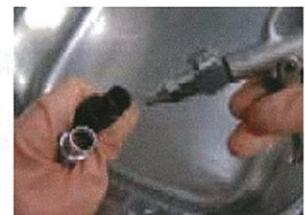
糸屑のでない布でハンドピースをよく拭きます。標準接続ケーブルのコネクター部分は特に注意して乾かせてください。接続部はエアガン(圧縮空気、窒素ガス)を使って水気を吹き飛ばしてください。
