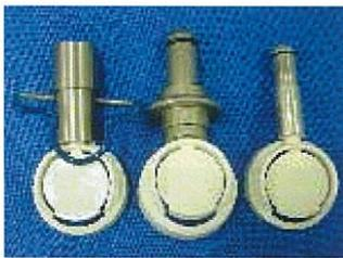
洗浄するアタッチメントにあわせ、ノズルを選択しスプレーヘッドへ装着させます。
