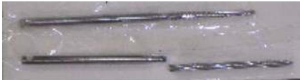
他社製バーとの併用はバー先の振幅を大きくし、バーの折損のみならず、アタッチメントの早期故障に繋がります。
