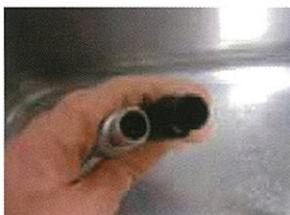
標準接続ケーブル両端の接続部分に水が直接入らないように、両端の接続部分を上に向けてもちます。
