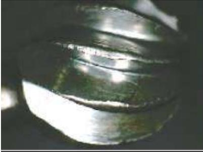
複数回使用するなどして摩耗したバーは切れ味の低下からアタッチメントに対する過度な負荷要因となり、アタッチメントの早期故障(先端部ベアリング破損等)に至る原因となります。
