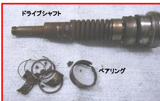
汚れて腐食したドライブシャフトと破損したベアリング
