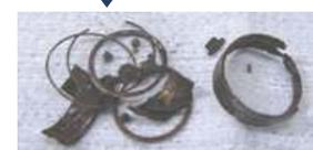
ベアリングの破損が進んだ状態
