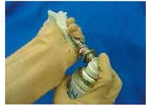
洗浄スプレーを噴射し、布でアタッチメント先端を軽く拭取ってください。拭取った液が無色になるまで、噴射と拭取りを繰り返します。
