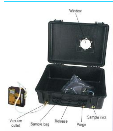
図2 捕集バッグサンプリングセット(8リットルバッグ)(SKCカタログより)
