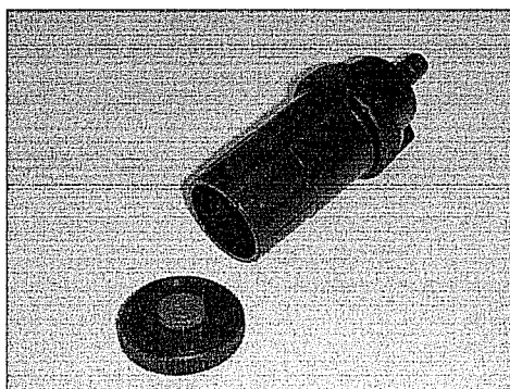
写真 1 カウル付ホルダーの例 (25mm φ のろ紙装着用)
