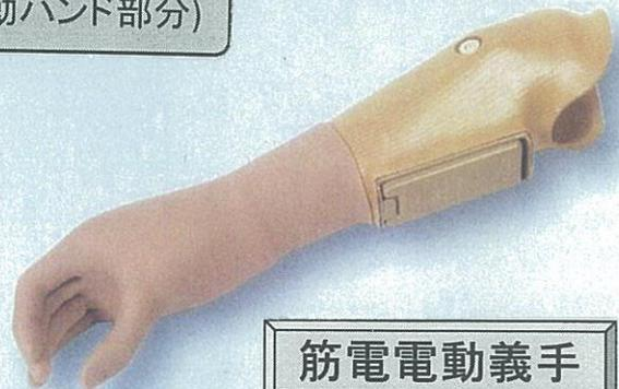
筋電電動義手
