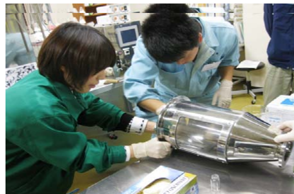
洗浄後の拭取り検査
