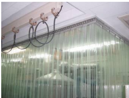
飛散する粉塵領域をカーテンで仕切って低減
