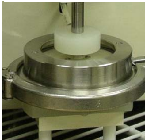
B) ケーキろ過層を取り出した
