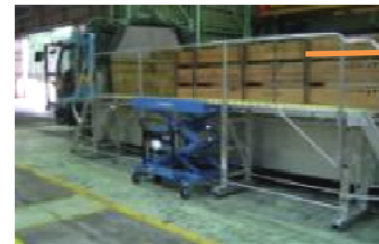
＜荷主事業場内で有効な荷役安全設備(移動式プラットフォーム)＞
