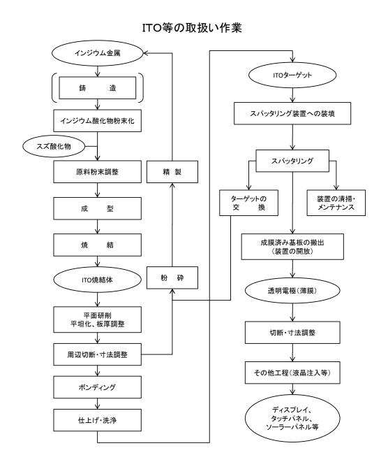
注: スパッタリングとは、真空中に不活性ガス(主にアルゴンガス)を導入しながら 基板とターゲット(成膜させる物質で金属や酸化物等)間に高電圧をかけ、イオン 化した不活性ガスをターゲットに衝突させて、ターゲット表面の原子をはじき飛ば して基板にターゲットと同物質の薄膜を得る方法。
