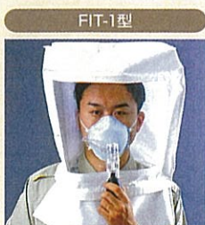
FIT-1型 フード内で甘味を感じるか否かによりマスクが顔にフィットしているかを確認します。
