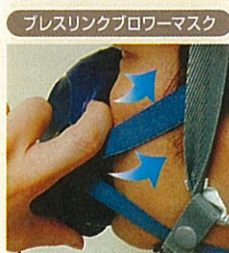
ブレスリンクブロウマस्क マスク面体の内圧が陽圧に保たれているため、顔面と面体との間にすき間が生じた場合でも、面体内に粉じんが漏れ込みにくいマスクです。
