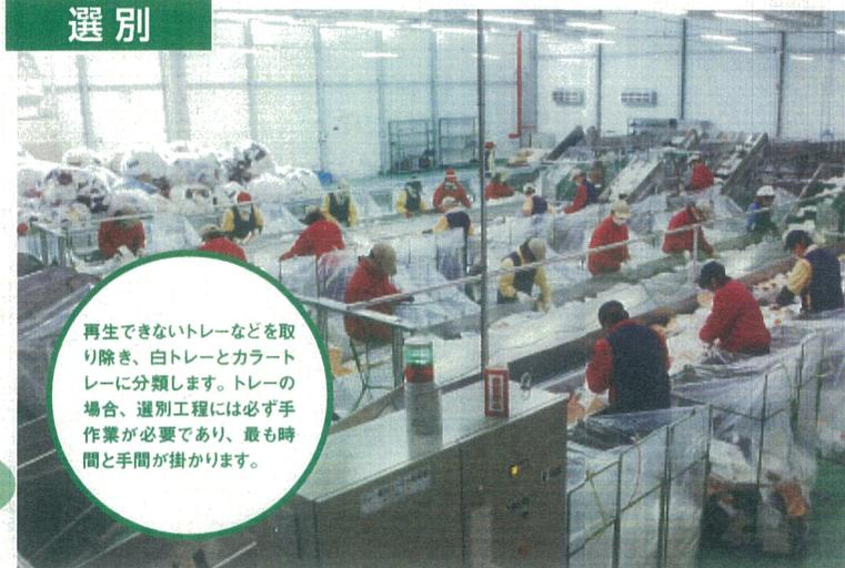
再生できないトレーなどを取り除き、白トレーとカラートレーに分類します。トレーの場合、選別工程には必ず手作業が必要であり、最も時間と手間が掛かります。
