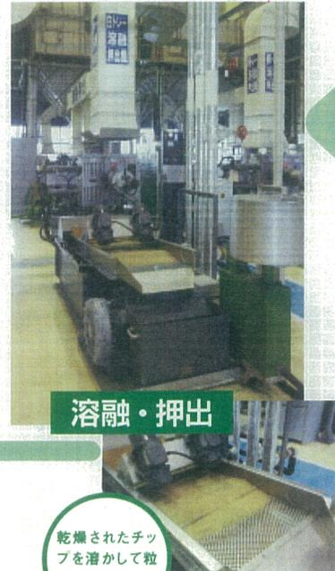
乾燥されたチップを溶かして粒状に加工します。
