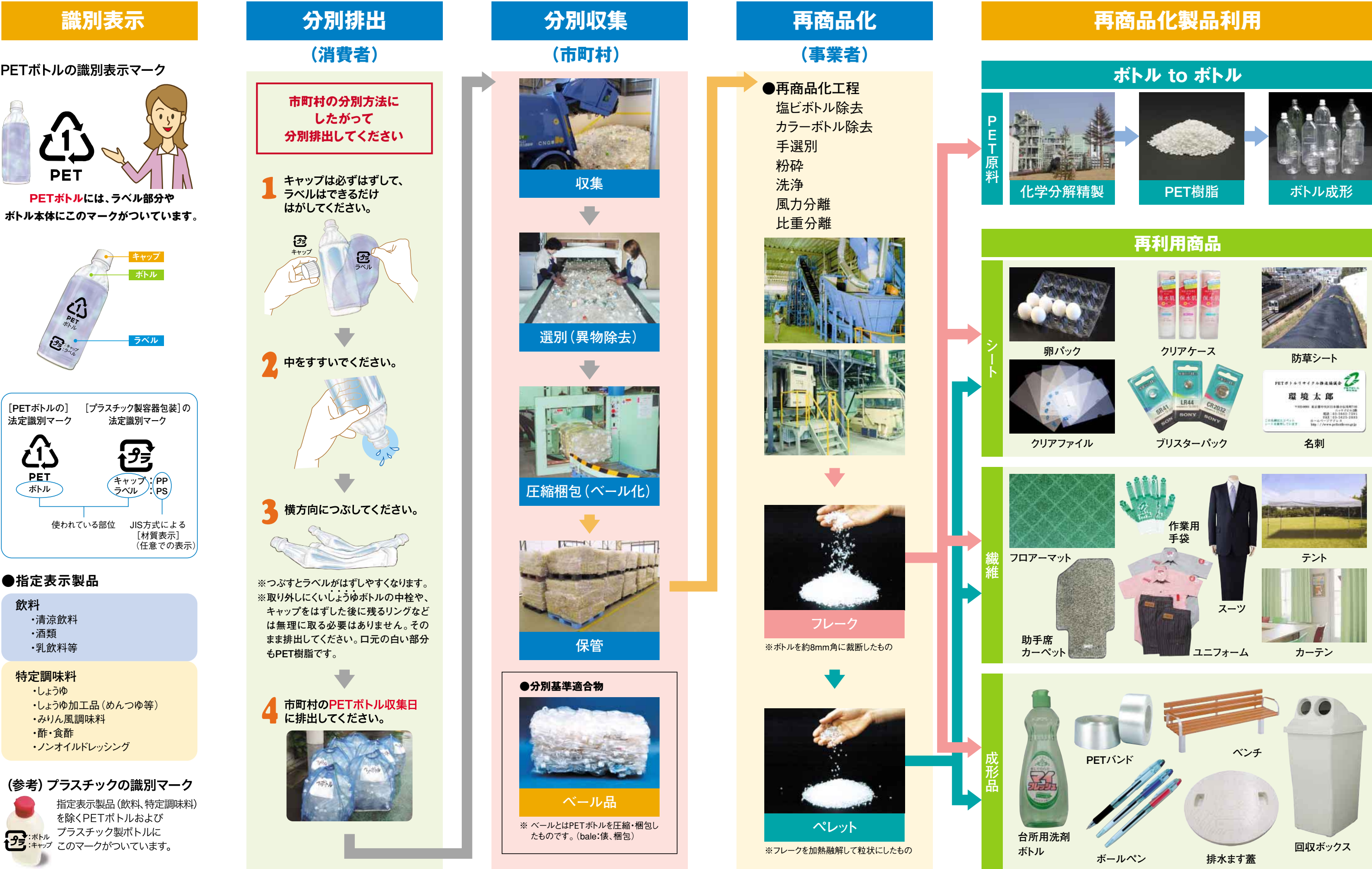
図14 PETボトル再商品化の流れ
