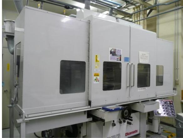
写真:加工機械密閉化の例
