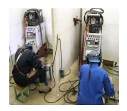
TIG溶接実習。難易度が高いチタン材の溶接を行っているところ。(チタンは他の金属より、溶接時に溶接棒が材料から離れにくいため、材料の厚さによる電流値や電極と材料の距離などを調整するための高い技能が必要となる。)
