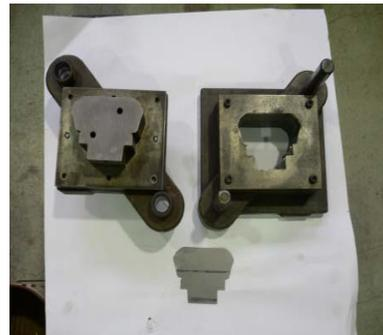
放電加工機による加工例
