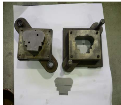
放電加工機による加工例
