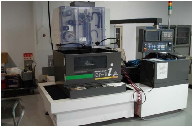
NCワイヤカット放電加工機（2,300万）
