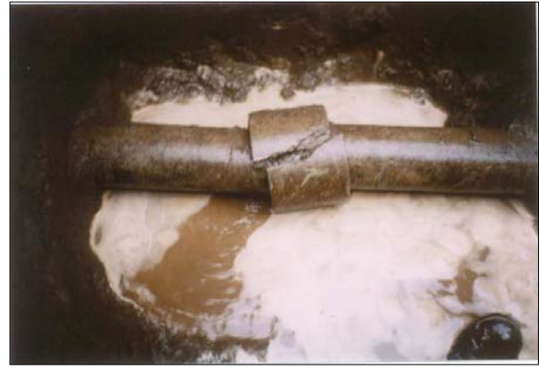
a) \phi 150 石綿セメント管 継手部抜け b) \phi 100 石綿セメント管 継手部割れ 写真3 石綿セメント管の破損例 (a : 十勝沖地震 5) 、b : 有珠山噴火に伴う火山性地震 6) )
