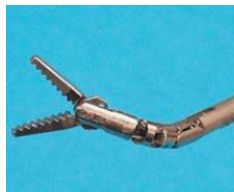
細径多自由度手術ロボット
