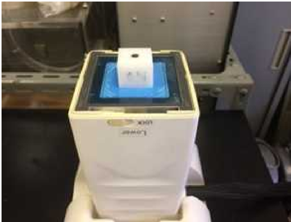
図10 小型ガンマカメラ（上部にポリエチレンブロック試料が置かれている）
