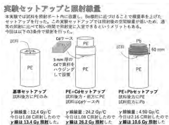
図 2 a. ターゲット近傍での室内での照射でのγ線量の計測
