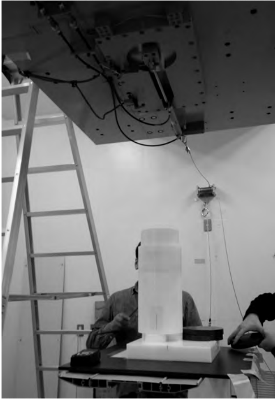
図 7a. 照射口からの中性子の漏えいを小さくするために照射口を覆うような構造としたファントム
