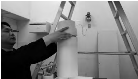
図 7e. 中性子を減速させるためにポリエチレンを追加しているところ
