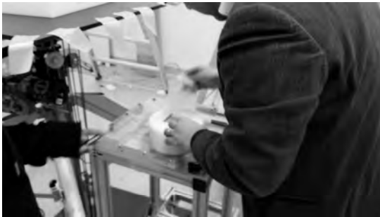
図 7e. 照射される熱中性子量を減らすためにカドミウムの箱に試料を挿入しているところ
