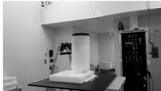
図 7d. \gamma 線量を減らすために鉛板を追加したところ
