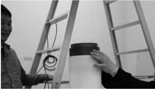
図 7e. 照射される \gamma 線量を減らすために追加された鉛板
