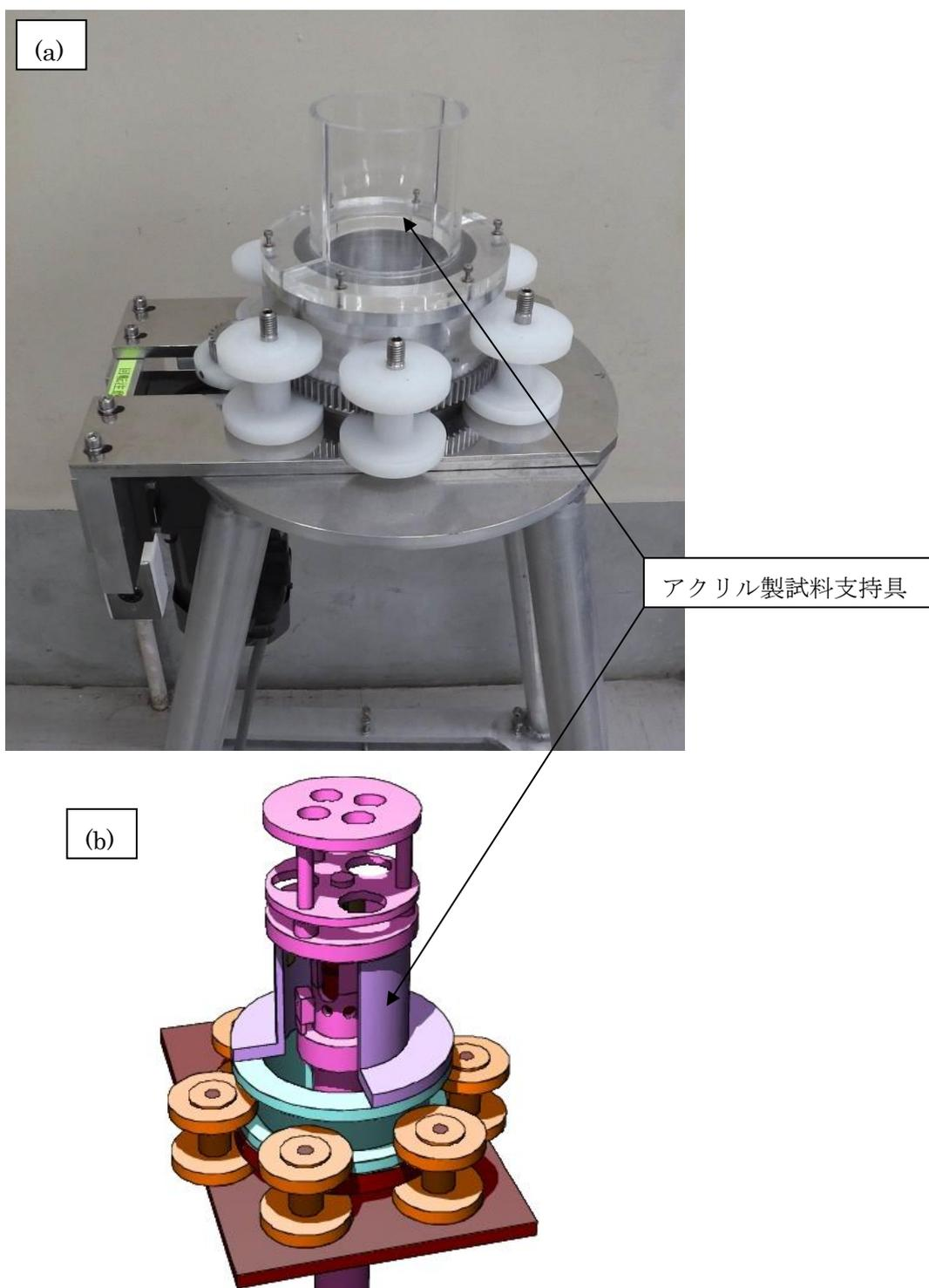
図 I.7 製作した高線量中性子照射装置とその MCNP 計算モデル
