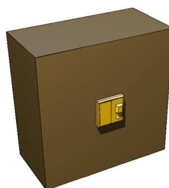
(c) TLD バッジを水槽形ファントム表面の中央に設置
