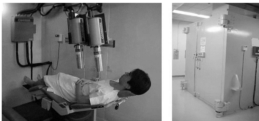
図 1 中性子被ばく線量測定に用いられた WBC [参考文献 3]
