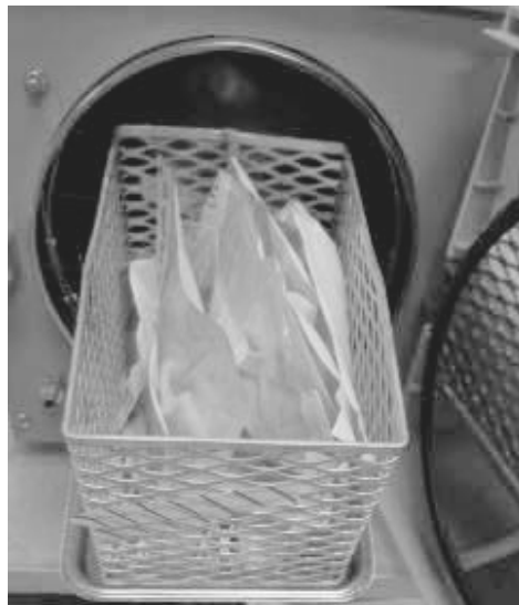
図 9. 詰めすぎでないオートクレーブ・バスケット
