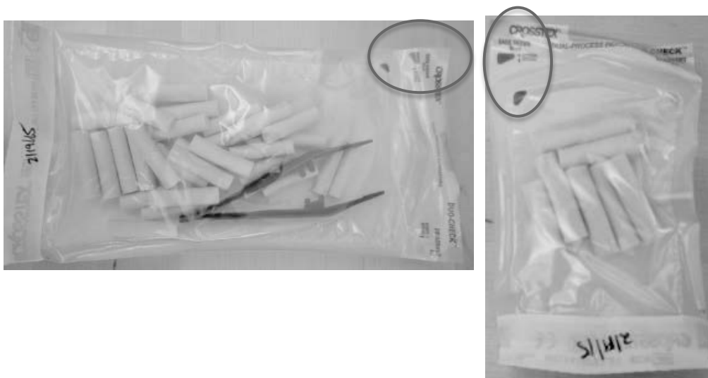
図 10 と 11. 色が変わりオートクレーブされたことを示すロール綿（それぞれの大きさの袋） 9. これで物品が利用可能となる。
