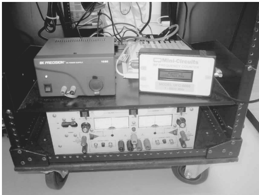
図 5: モジュレーションアンプ、周波数カウンタ、磁場掃引用電源装置
