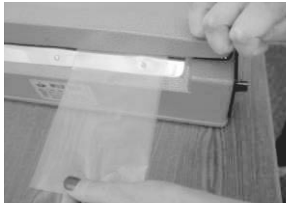
図 14. ヒートシーラーを用いたポリのチューブ作成
