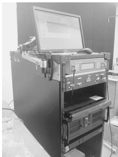
図 1: EPR スペクトロメータ装置の全景 上からディスプレイ、ロックインアンプ、ブリッジ、制御用コンピュータ、サージ防止装置、変調アンプが示されている。この下に磁場掃引用の電源装置がある。
