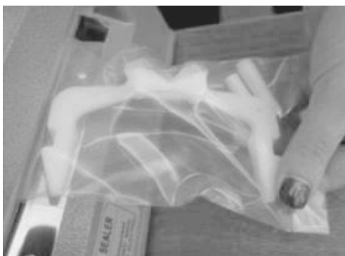
図 20. バイトブロックが入った袋をヒートシーラーで封じます
