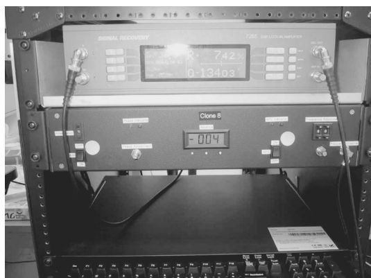
図 3: ロックインアンプとブリッジ
