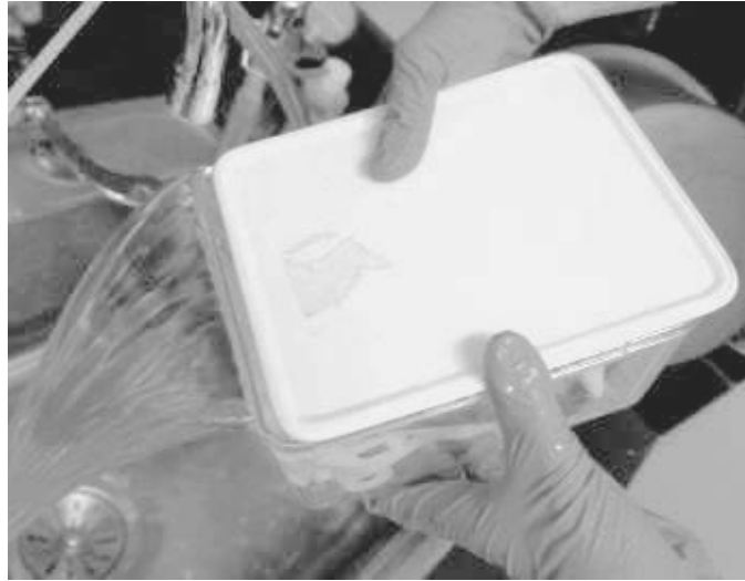
図 5. 部品が流れ落ちないように蓋を用いて水を外に出す。
