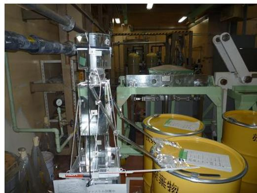
図3 原子力機構燃料試験施設におけるモニタリング試験の様子（簡易物理ファントムに試作した OSL 線量計を取り付け、作業環境に設置）
