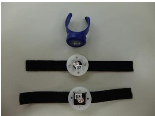
図8 試作 OSL 線量計の外観(ケーシングを開口し、アルミマイラー製遮光膜を取り付けたもの)
