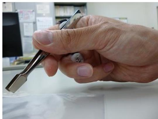
図10 試作 OSL 線量計の使用例(指に2個着用している)
