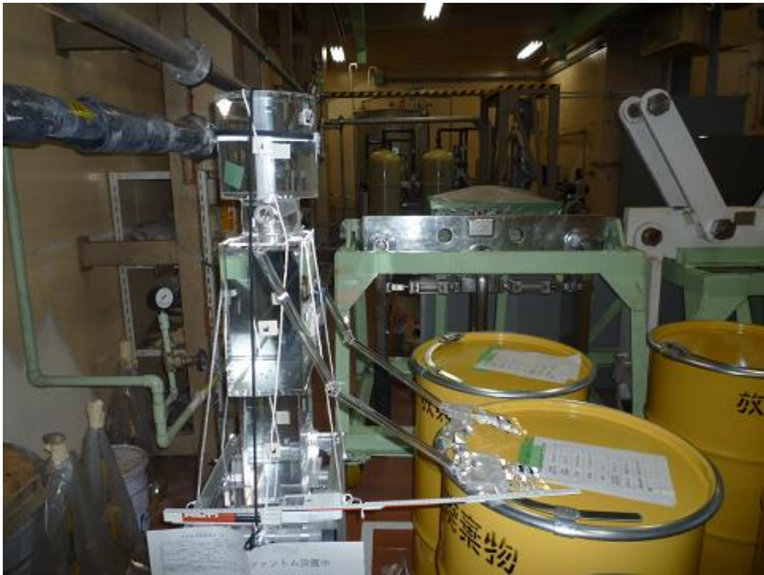
図7 原子力機構燃料試験施設におけるモニタリング試験の様子 (簡易物理ファントムに試作した OSL 線量計を取り付け、作業環境に設置)
