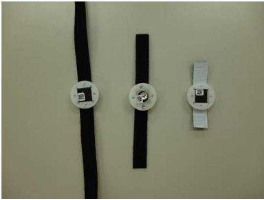
図6 試作した OSL 線量計及び装着治具の外観 (左右: 3mm 個人線量当量モニタリング用。中央: 70 \mu m 個人線量当量モニタリング用)
