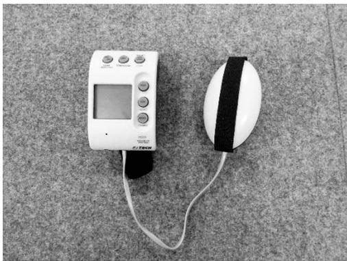
図2 Hand-Held dynamometer
