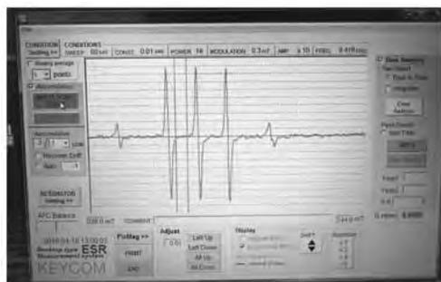
図 3 : ESR 装置による標準波形
