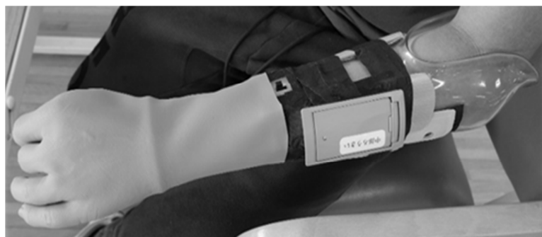
図2 評価用筋電義手(a:全体 b:屈曲リスト付トランスカーパルハンド)
