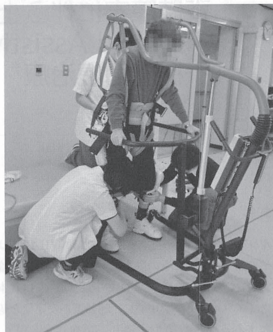
図 3. HAL の装着。吊り下げ型免荷式歩行器を利用し立位を保持した状態で、主に 3 名の装着補助者によって HAL の装着を実施している。装着時間は 2 分半～3 分程度である。
