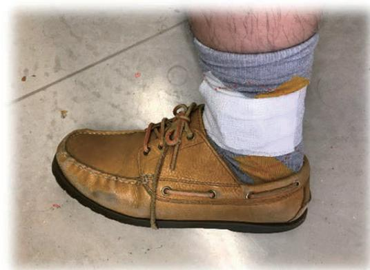
左右の外果に、センサーの向きを揃えて固定。被験者のもつスマートフォンに、Bluetooth を介して送信され、内部ストレージに保存可能である。データ取得用のアプリケーション“DeviceMotionTest”は、iOS 上で作動するもので、本研究のために研究分担者 松下によって開発された。複数センサーからの加速度、角速度が同時に実時間で取得できる機能を備えている。下図は、本アプリケーションを起動後、複数の WESU1 センサーデバイスを認識した所を示す。
