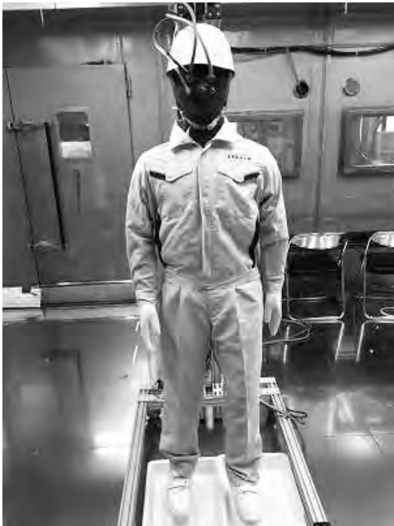
図 1 核心温評価用発汗サーマルマネキン（NEWTON、Measurement Technology NW）による実験風景
