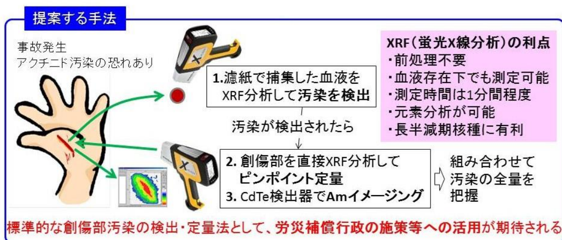
図1 本研究で提案している創傷部アクチニド汚染の定量分析法
